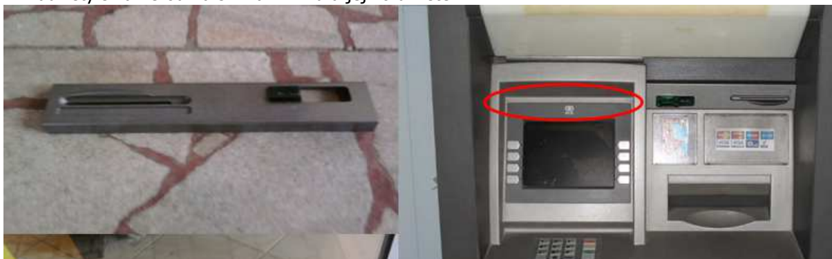
Příklad lišty s kamerou na snímání PINu a jejího umístění
