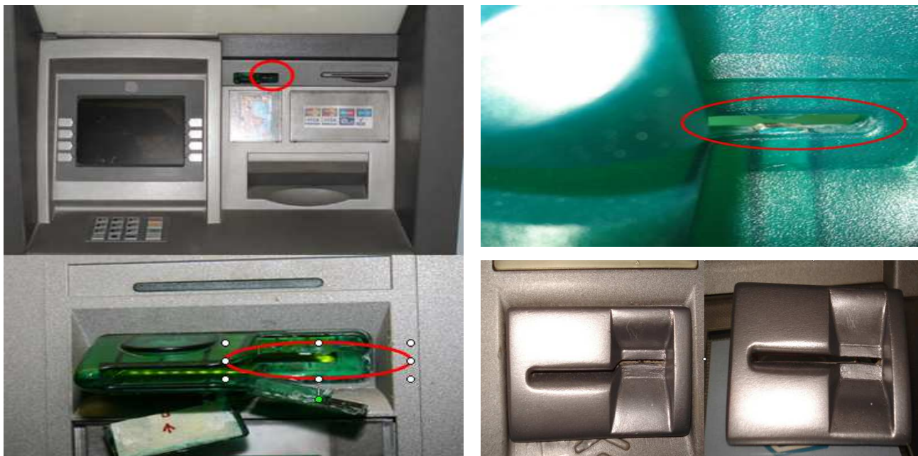
Varianty kopírovacího zařízení a jeho umístění na ochranném nadstavci
