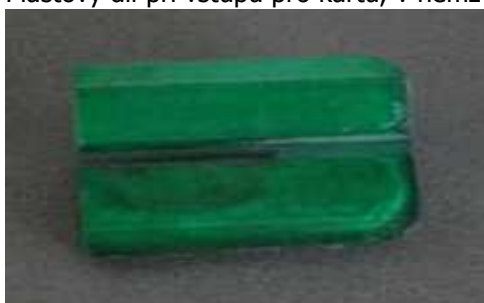
Plastový díl při vstupu pro kartu, v němž je namontováno kopírovací zařízení
